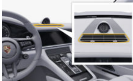
рис. 57: Верхнє поле обдування
