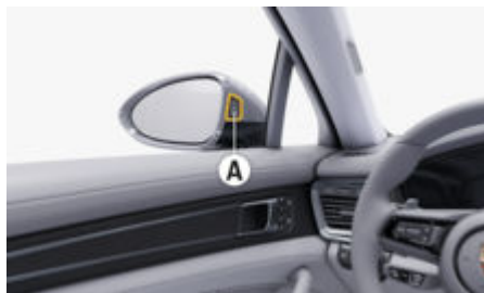
рис. 134: Індикатор А в зовнішньому дзеркалі заднього виду
