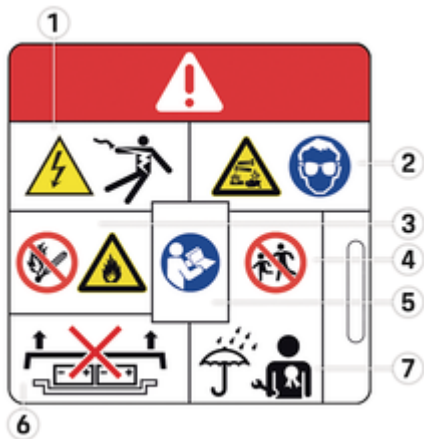
рис. 2: Попереджувальне маркування на високовольтному акумуляторі
