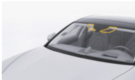
рис. 166: Кріплення пристроїв оплати дорожнього мита
