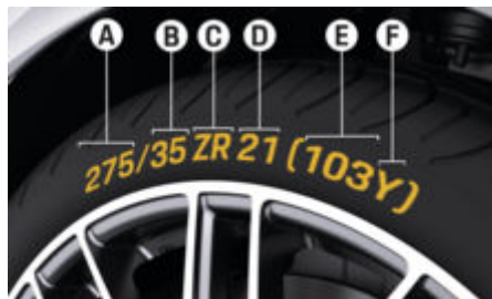
рис. 238: Напис на шині
