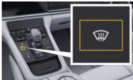
рис. 60: Розморожування вітрового скла
