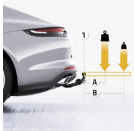
рис. 187: Принципова схема розподілення навантаження монтажних деталей і приладдя
