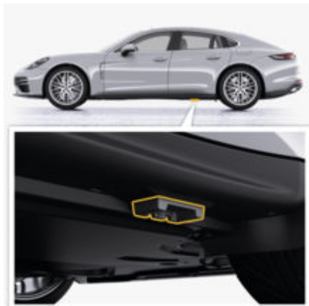
рис. 252: Точка опори для підйомника й домкрата ззаду
