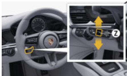
рис. 89: Установлення потрібної дистанції
