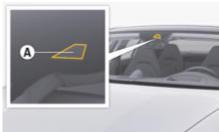
рис. 114: Камера на вітровому склі
