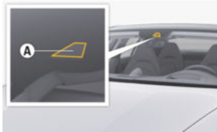
рис. 130: Камера на вітровому склі
