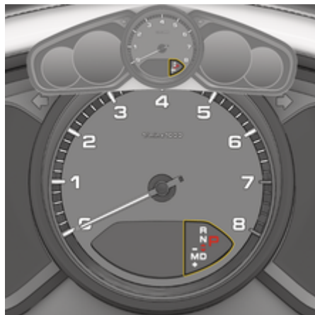
рис. 96: Індикація робочого режиму та ввімкненої передачі на комбінованій панелі приладів
