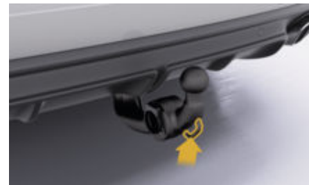
рис. 186: Використання кріпильного вушка на шаровій голівці
