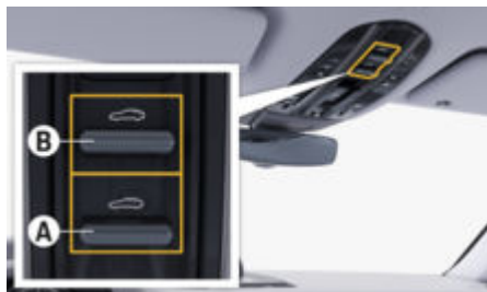
рис. 24: Відкривання й закривання сонцезахисної шторки
