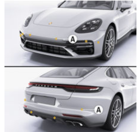
рис. 108: Ультразвукові датчики для вимірювання відстані
