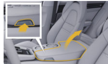
рис. 179: Відкривання відділення для дрібних речей у передньому підлокітнику
