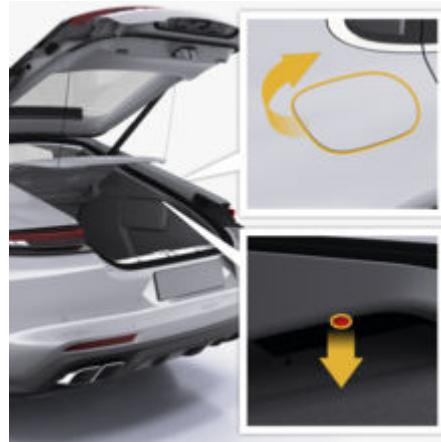
рис. 250: Виконати аварійне розблокування кришки паливного бака
