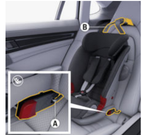
рис. 49: Установлення дитячої утримувальної системи з точкою кріплення ISOFIX (TopTether)
