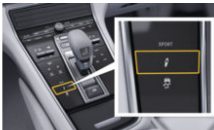
рис. 112: Кнопка PASM на центральній консолі
