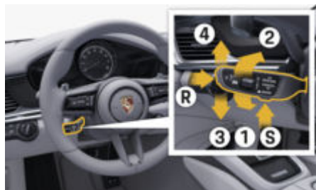
рис. 141: Керування помічником руху в заторі
