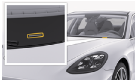
рис. 253: Розташування ідентифікаційного номера автомобіля
