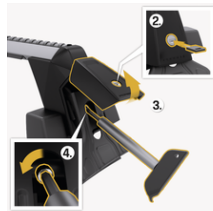
рис. 190: Розблокування та піднімання кришок
