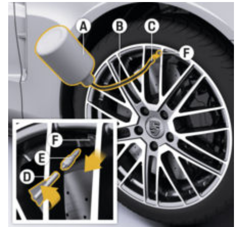
рис. 243: Заливання герметика для шин
