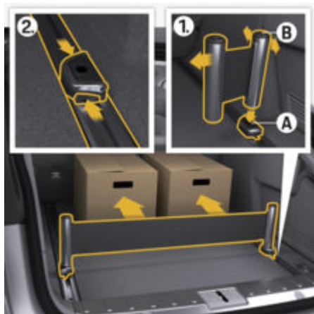
рис. 213: Встановлення пристрою для розмотування ременя
