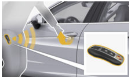
рис. 28: Відмикання дверей за допомогою системи комфортного доступу Porsche
