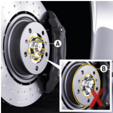
рис. 239: Поверхні прилягання колеса
