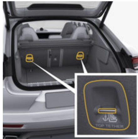
рис. 48: Автомобілі з трьома сидіннями в задній частині салону: точки кріплення ISOFIX (Top Tether)
