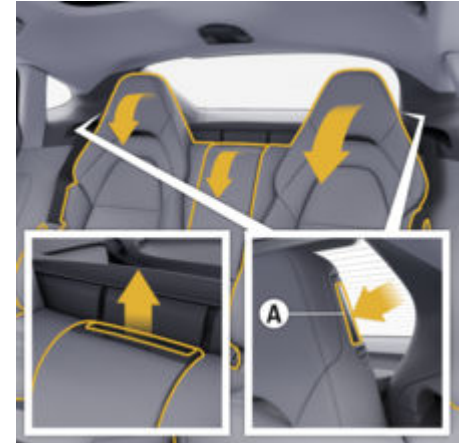
рис. 73: Складання спинок задніх сидінь
