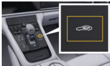
рис. 58: Увімкнення та вимкнення рециркуляційного режиму
