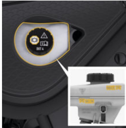
рис. 228: Бачок гальмівної рідини
