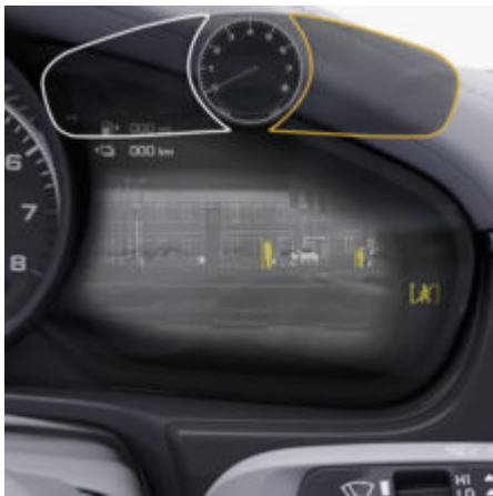
рис. 105: Термографічне зображення системи нічного бачення
