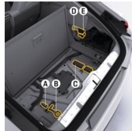
рис. 204: Виймання бортових інструментів
