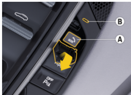
рис. 235: Кнопка SOS і контрольна лампа
