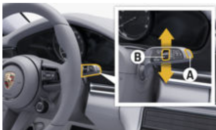
рис. 125: Кнопка очисника заднього скла А й перемикач режимів чутливості датчика дощу В
