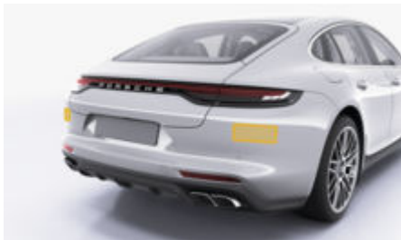
рис. 133: Радарні датчики в задньому бампері
