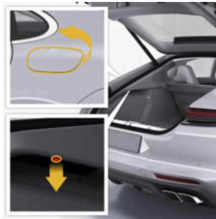
рис. 234: Аварійне розблокування клапана заряджання
