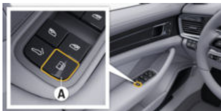
рис. 247: Кнопка А: Запуск вентиляції паливного бака та розблокування кришки паливного бака
