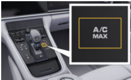
рис. 53: Увімкнення й вимкнення режиму A/C MAX
