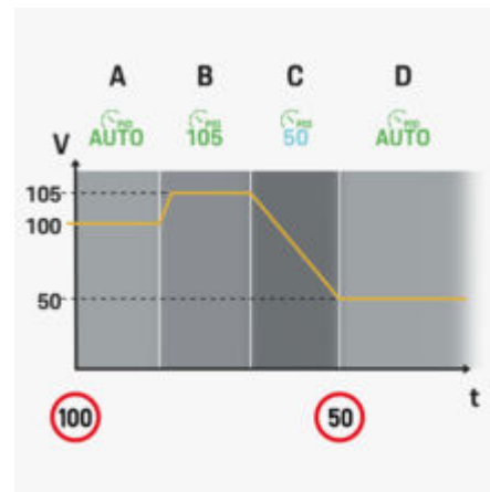
рис. 120: Приклад регулювання системи Porsche InnoDrive
