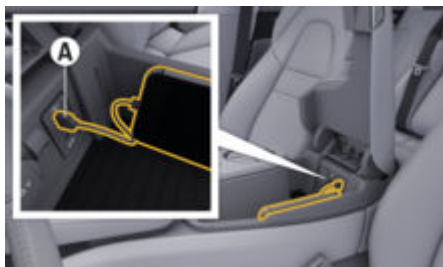
рис. 160: Інтерфейс USB (типу C) у центральному підлокітнику
