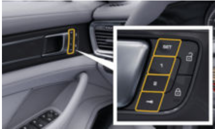
рис. 66: Кнопки пам'ятi на дверях водiя (пакети пам'ятi налаштувань для водiя та комфорту)
