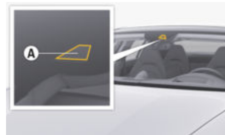
рис. 103: Фронтальна камера на вітровому склі
