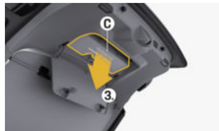
рис. 201: Виймання аптечки та знака аварійної зупинки
