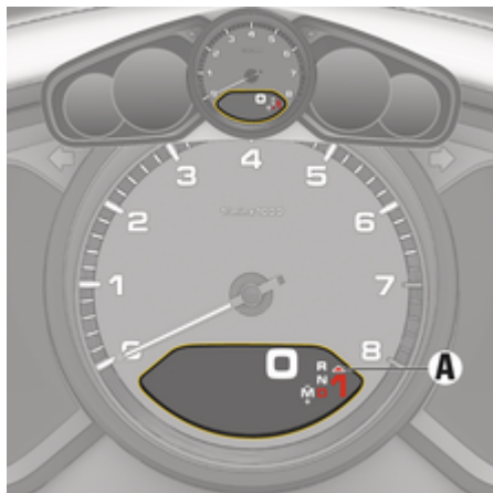
рис. 99: Індикатор увімкнення наступної передачі A
