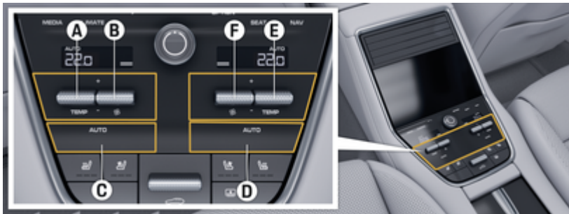
рис. 52: Короткий огляд системи кондиціонування задньої частини салону
