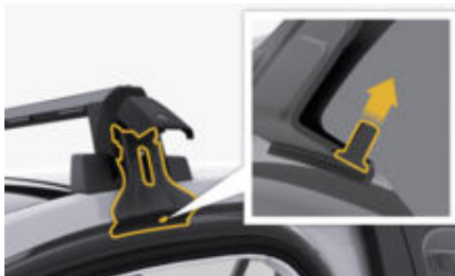
рис. 193: Установлення стопорних штифтів
