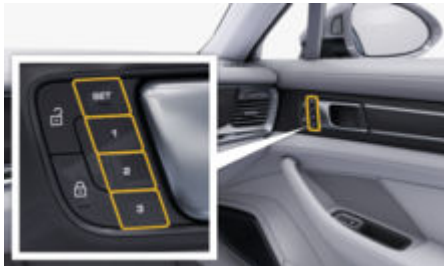
рис. 67: Кнопки пам'ятi на дверях переднього пасажирa (пакети пам'ятi налаштувань для водiя та комфорту)
