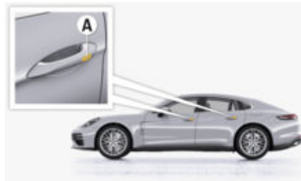
рис. 26: Система комфортного доступу
