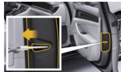
рис. 33: Виконання аварійного розблокування/блокування
