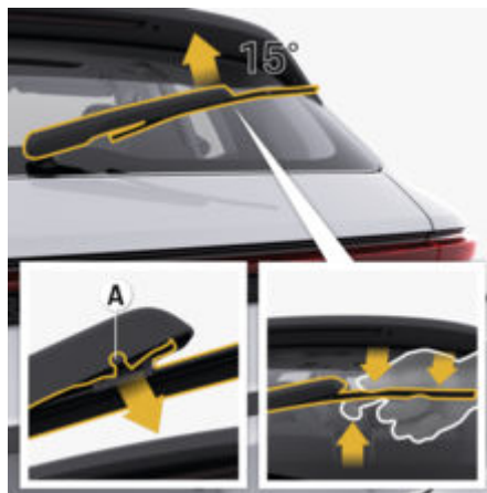
рис. 129: Заміна щітки очисника заднього скла
