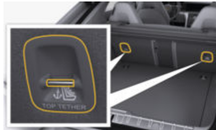
рис. 47: Автомобілі з двома сидіннями в задній частині салону: точки кріплення ISOFIX (Top Tether)
