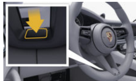
рис. 65: Кнопка обігрівання кермового колеса
