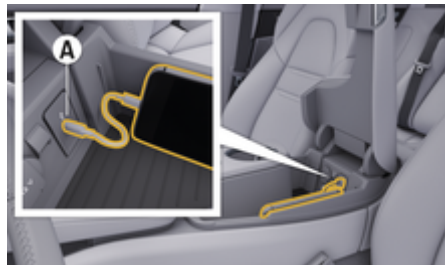
рис. 172: Інтерфейс USB (типу C) у підлокітнику
