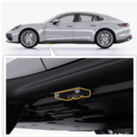
рис. 251: Точка опори для підйомника й домкрата спереду
