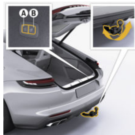
рис. 185: Висування та прибирання тягово-зчпного пристрою
