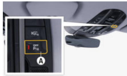
рис. 110: Вимкнення системи ParkAssistent
