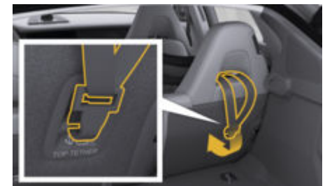
рис. 50: Фіксація кріпильного ременя ISOFIX (Top Tether)
