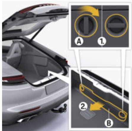
рис. 198: Відкривання поворотних засувки і обшивки
