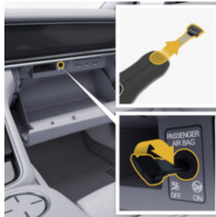
рис. 44: Вимкнення подушки безпеки переднього пасажир
