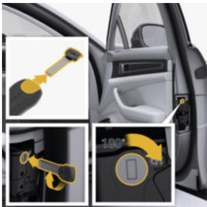
рис. 34: Аварійне блокування дверей переднього пасажиря
